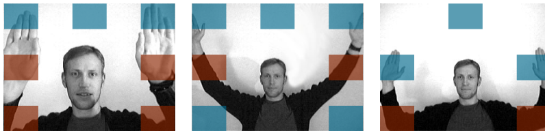
zu hohe Anzahl oder ungünstige Positionierung kann zum unbeabsichtigten Auslösen der falschen Box führen (problematische Boxen in rot)
