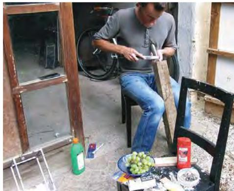
Bearbeiten der Metalloberfläche mit einer Feile
