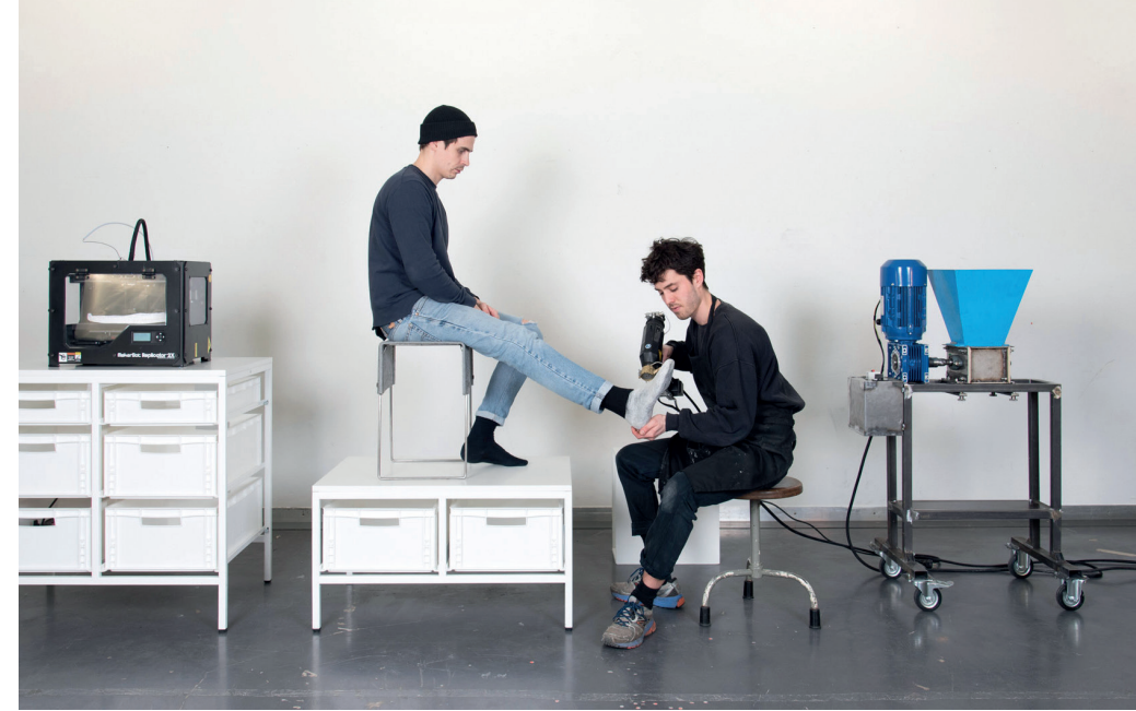
Johannes Voelchert, Pressure-Made. Produktion von kreislauffähigen Sneakern: on demand gesprüht mit 3D-gedruckter Sohle aus recykliertem Monomaterial/ Production of recyclable sneakers: sprayed on demand with 3D-printed sole made from recycled mono-material.
