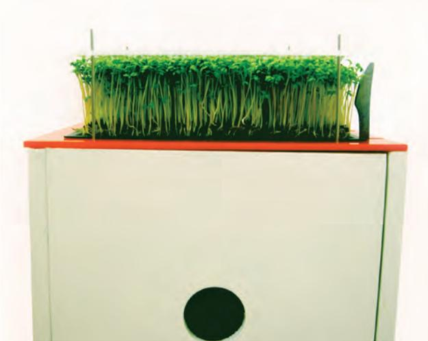
*Drei Hebel am hinteren Ende des Korpus' - angestoßen durch die auf der Kresse liegende und somit mitwachsende Acrylplatte - lösen die Mechanismen aus, indem sie Stahlkugeln von ihrem Podest stoßen.*
