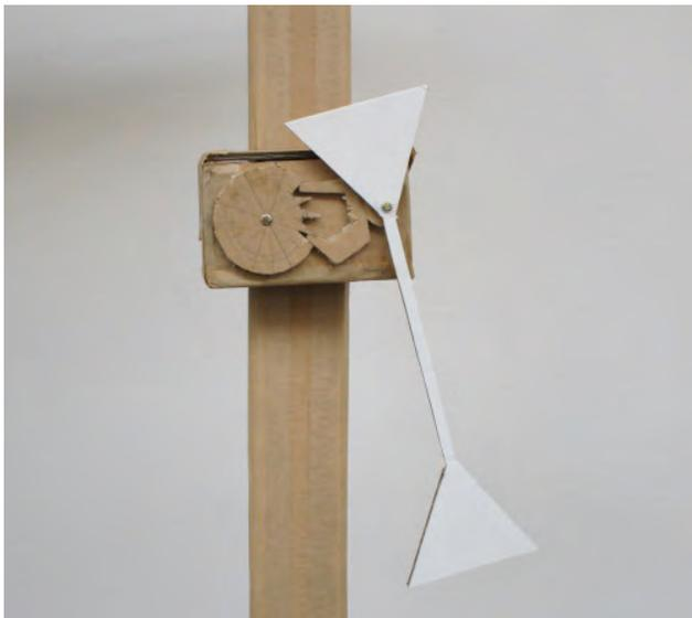
*Wir führten Experimente zum Pendel durch und stellten fest, dass der Masseschwerpunkt der Pendels die Pendeldauer beeinflusst.*
