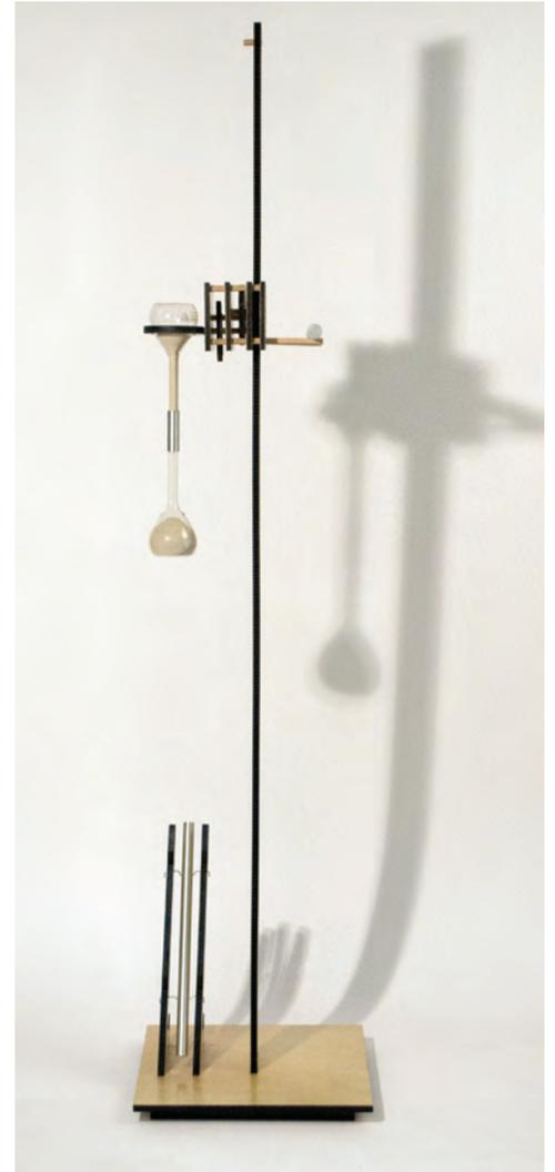
*Am Ende der eingeteilten Zeit schlägt das Pendel gegen ein sanft aufgehängtes Aluminiumrohr und wird von diesem gestoppt. Das Rohr lässt sich auch herausnehmen und in die Halterung am Fuß der Aufhängung legen.*
