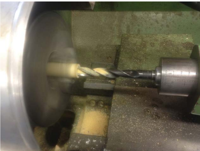
Aufbohren der Bambusrohre auf den exakten Innendurchmesser
