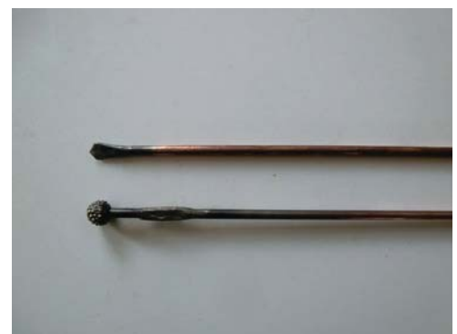
Selbstgemachte Bohrer zum vollständigen Durchbohren der Bambusrohre
