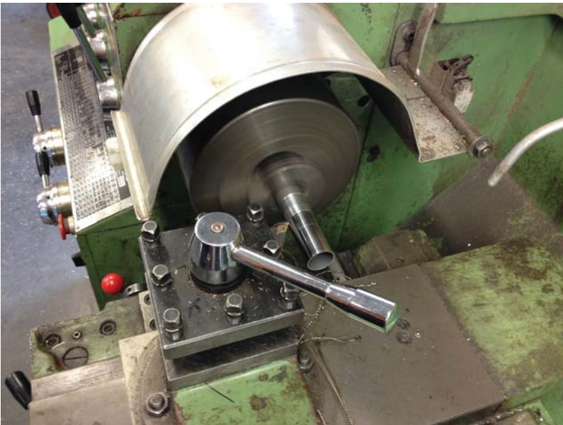
Abdrehen der Stahlrohre
