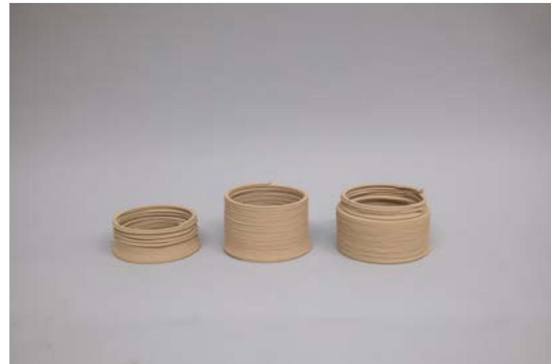
Die 3mm Nozzle ist faktisch nicht zu empfehlen. Durch die Mengen an Material, wird viel Druck benötigt und die Wandstärke wird immens. Die Materialförderung kann unterbrochen werden, der Drucker scheint nicht dafür ausgelegt zu sein (Objekt ganz rechts).
