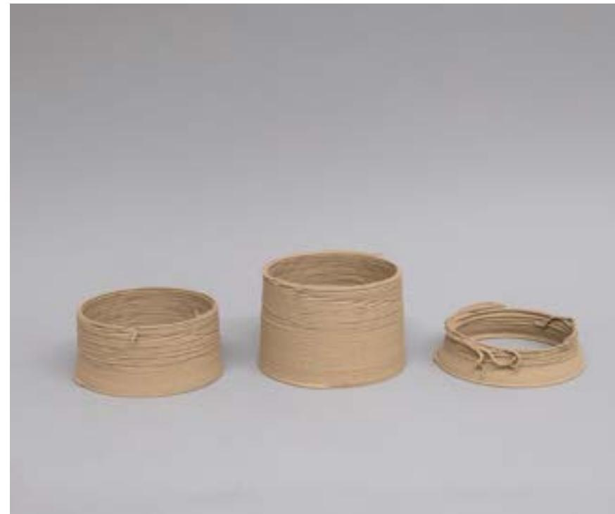
Diese Fehler sind durch schnelle Fahrbewegungen entstanden, Speed 80 %.
