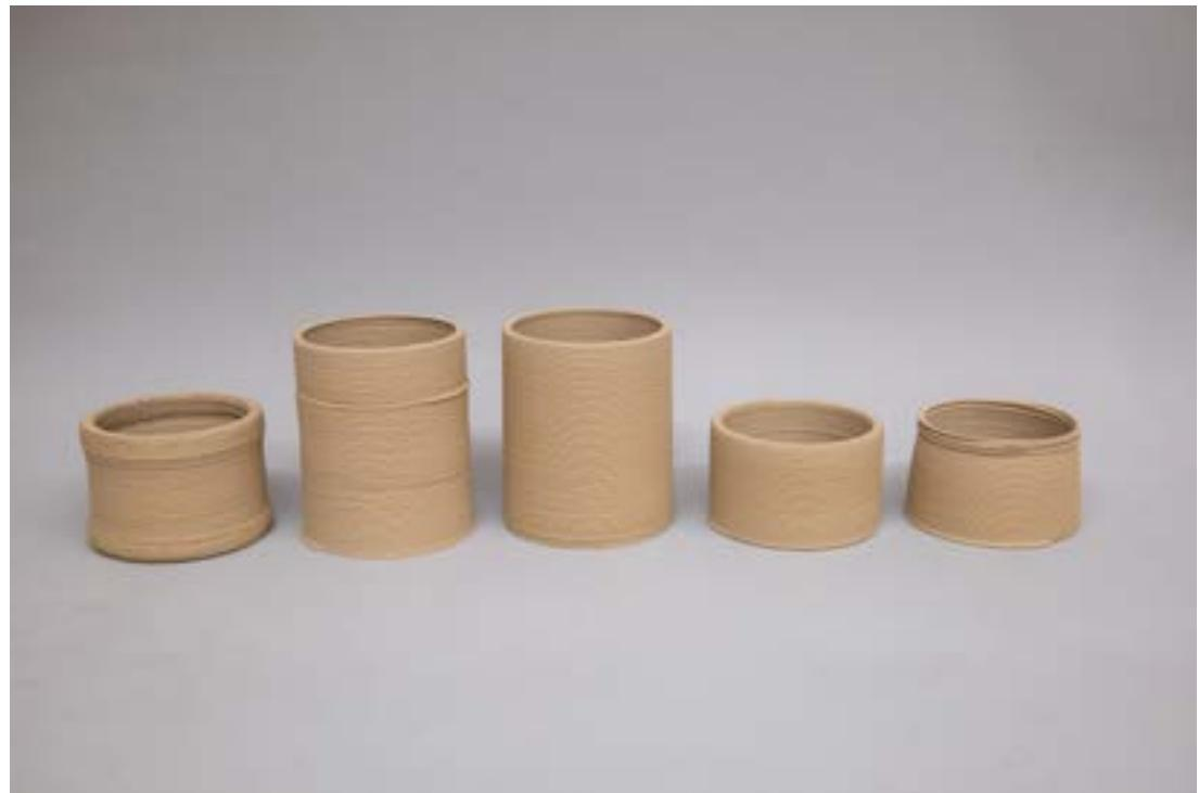
Die vierte Masse war ein Hybrid aus Masse 1 (die zu trocken war zum drucken) und seit dem mehrere Tage geruht hat, und 10 ml frischem Wasser.
