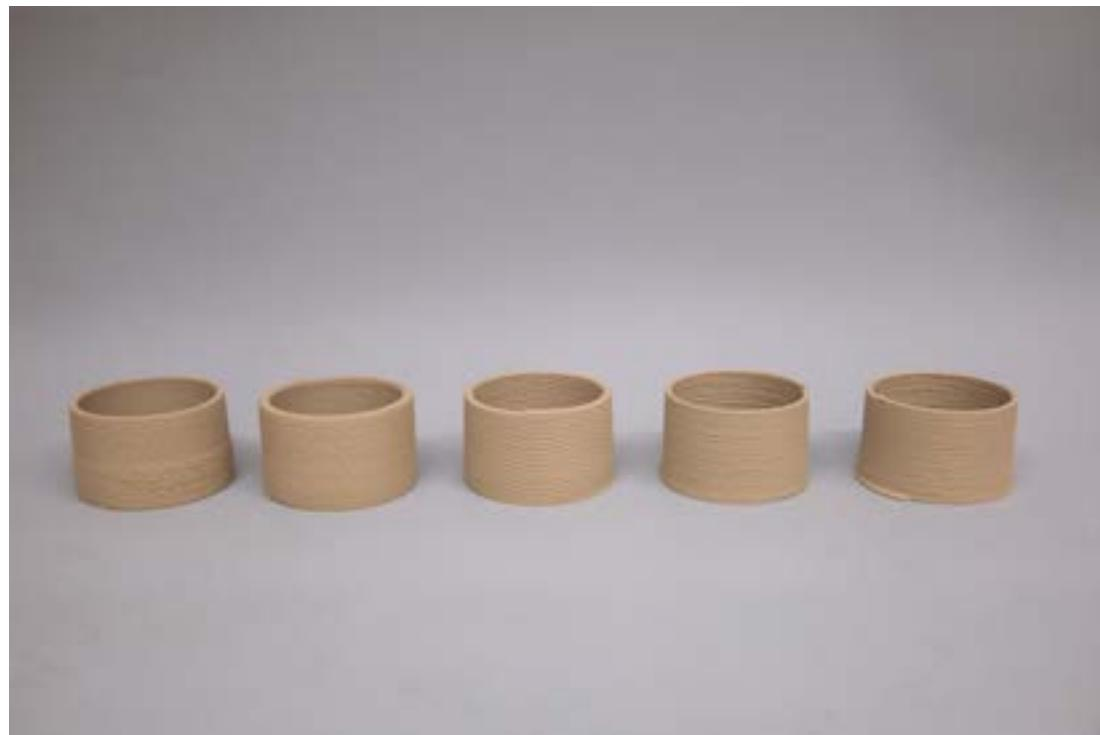
Masse 5, wurde unter den gleichen Bedingungen wie die Beste Masse (Masse 2) angerührt, aber in der Menge verdoppelt. Die Massen sind sehr ähnlich geworden. Daraus lässt sich folgern, dass die erarbeiteten Einheiten skalierbar sind.
