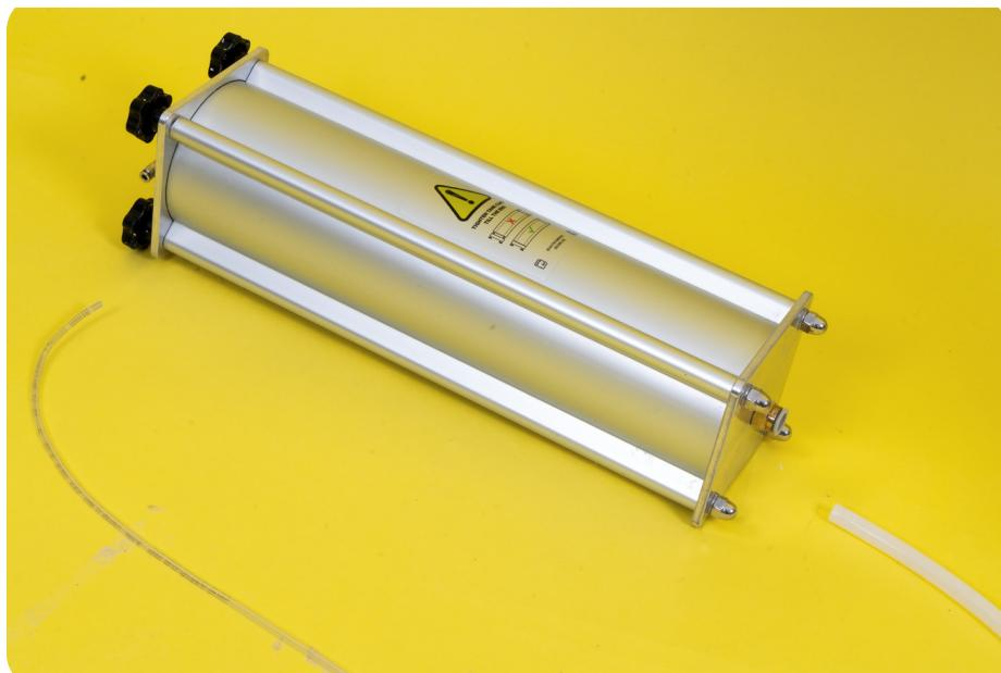
Das andere Ende des dünnen durchsichtigen Teflonschlauchs wird an der Kartusche angebracht.
