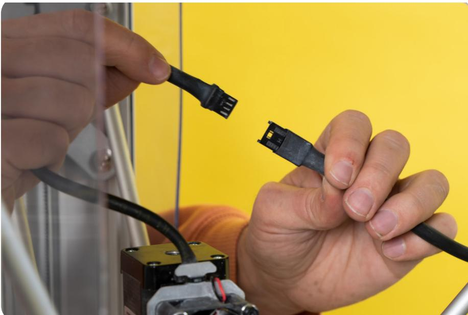
Extruder durch das schwarze Kabel mit dem Drucker verbinden.
