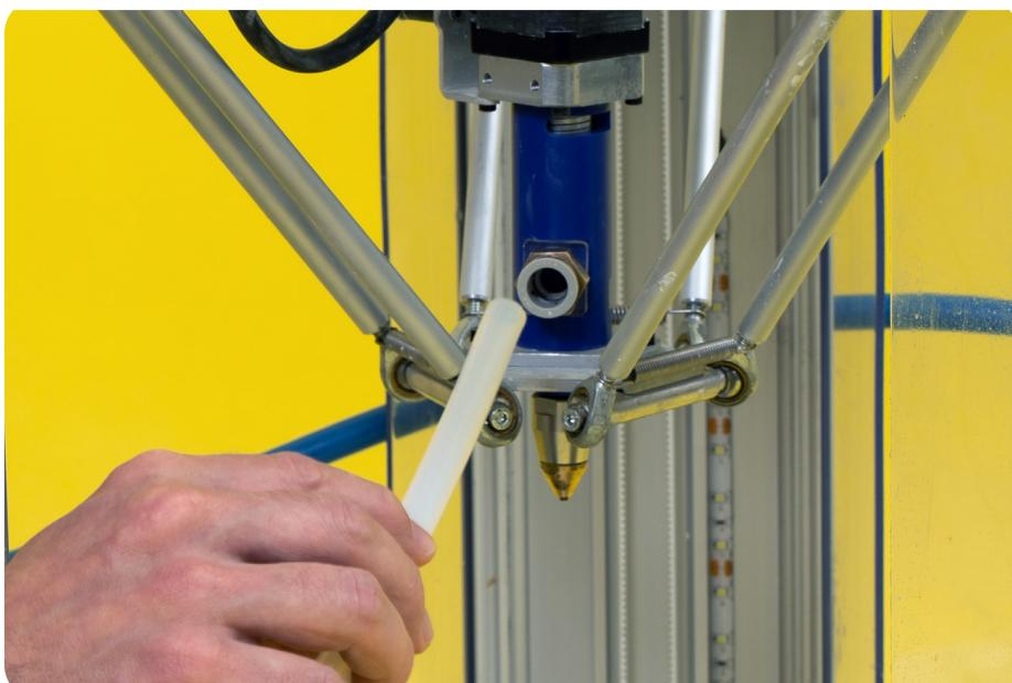
Nachdem der Extruder am Drucker befestigt wurde, wird das andere Ende des dickeren milchig weißen Teflonschlauchs an den Extruder gesteckt.
