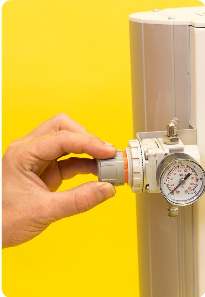
Druckregler am Drucker öffnen durch Drehen des grauen Reglers. Der Regler muss dafür ein Stück herausgezogen werden, sodass die rote Markierung zu sehen ist.
