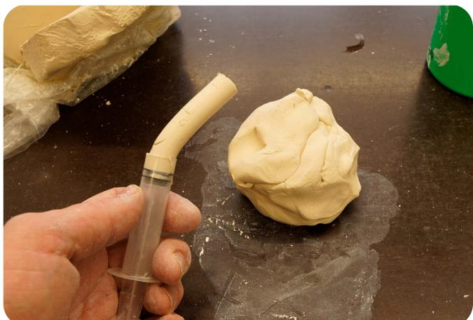
Die vorbereitete Masse in die Spritze (in der Schublade) füllen. Wenn sich die Masse direkt biegt, ist zu viel Flüssigkeit darin. Wenn sich die Masse nicht biegt, ist zu wenig Flüssigkeit enthalten. Eine leichte Biegung, wie auf dem Foto zu sehen, zeigt ein gutes Mischverhältnis.
