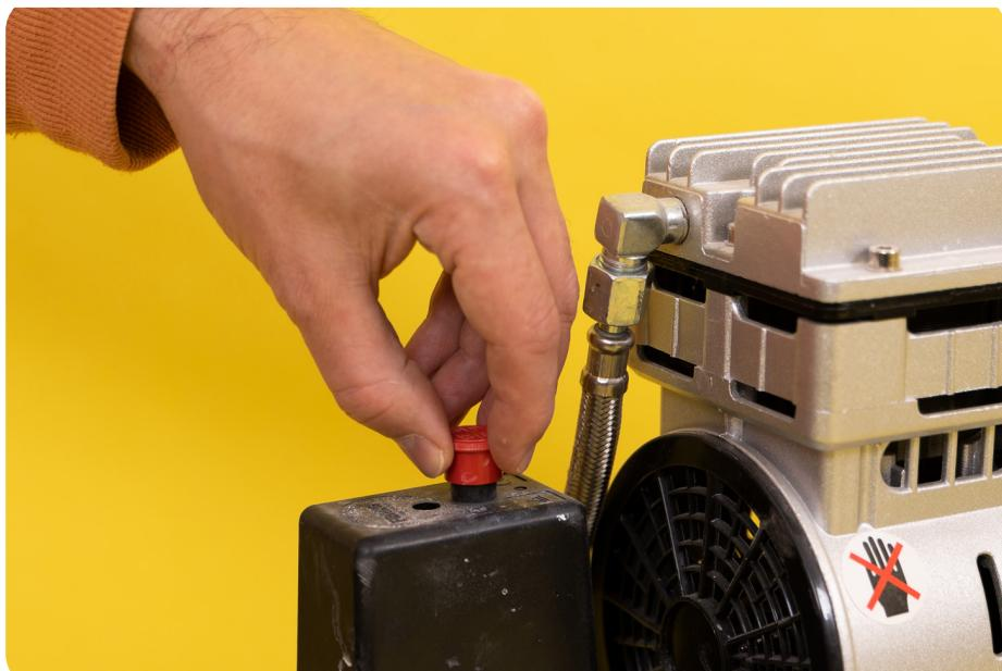
Sobald Kompressor, Kartusche und Drucker verbunden sind, wird der Kompressor ange- schaltet, indem der rote Knopf nach oben gezogen wird.
