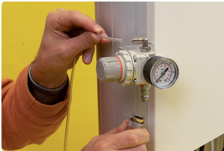
Der blaue Schlauch des Kompressors und der dünne durchsichtige Schlauch werden an den Druckminderer gesteckt.
