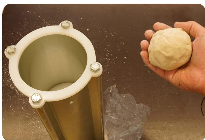
Die fertig vorbereitete Masse formt ihr in handgroße Kugeln und werft sie mit Wucht in die Kartusche. Drückt anschließend mit der Faust etwas nach, um möglichst wenig Luft einzuschließen.
