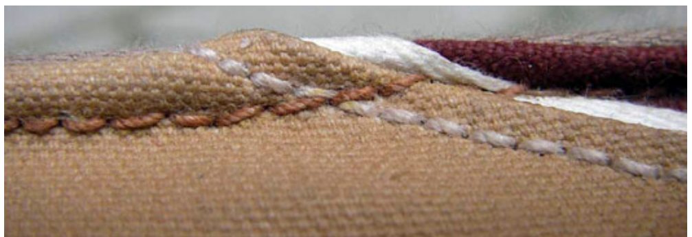
Schwierige Nähstelle im Bereich der Aufdopplung
