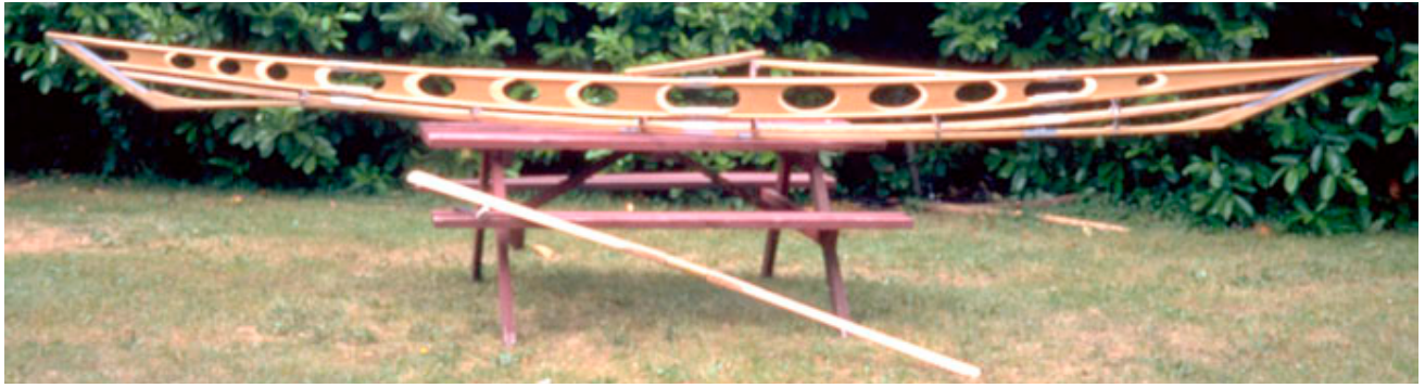
Das nachgebaute Gerüst, welches im Vergleich zum Original sehr steif ist.
