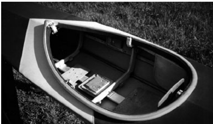
Luke des zweiten Kajaks mit Verstärkung des Decks
