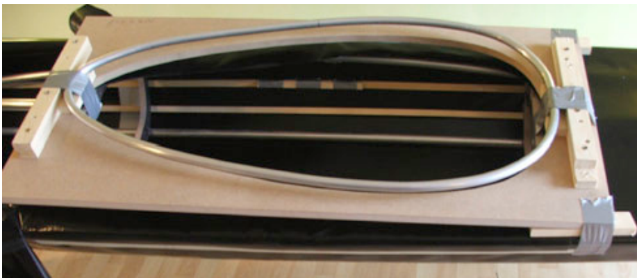
Der Süllrand wird mit Hilfe einer festen Schablone geklebt
