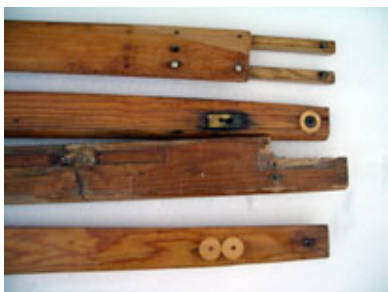
Teilweise reparierte Bordwände
