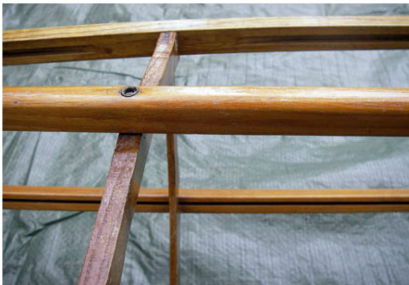
Spant- Dollbordverbindung mit Ausfräsung
