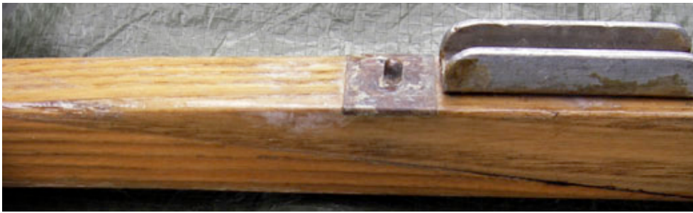
Schäftung von Hart- und Weichholz an der Kielleiste
