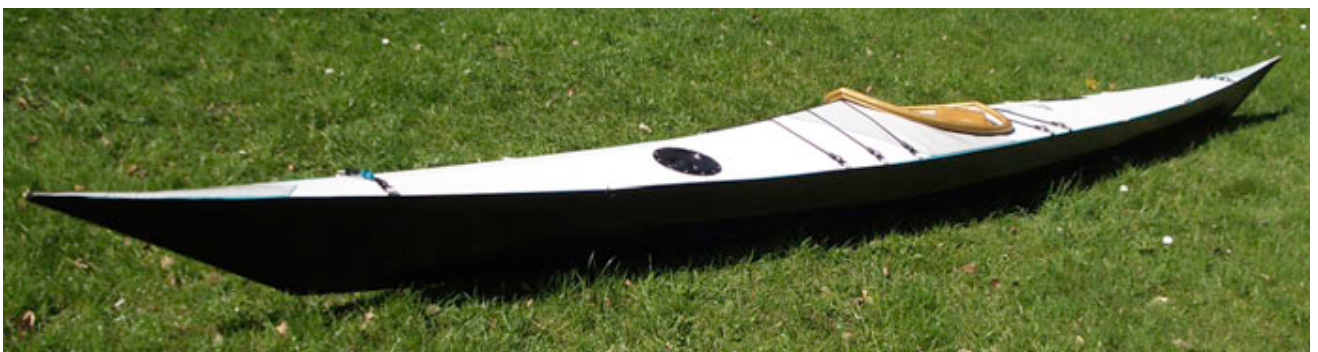
Durch die flachere Seitenlinie musste der Bereich vor der Luke höhergezogen werden
