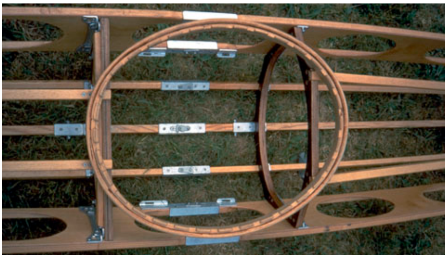
Die Gerüstmitte mit aufgelegtem Stül
