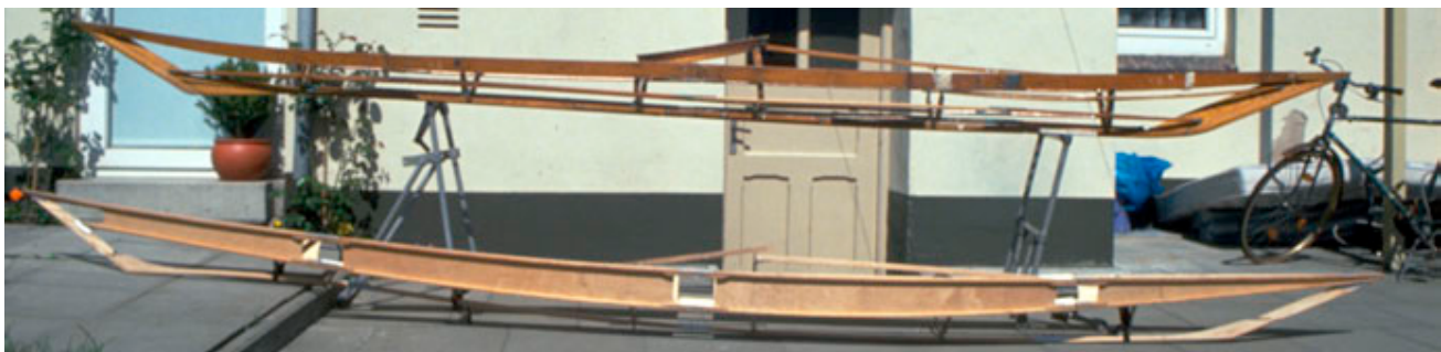
Das Hartel Originalgerüst von A. v. Rautenfeld auf den Böcken lagernd und darunter der unvollständige Nachbau. Der unterschiedliche Decksprung und die vordere Hilfssente im Original sind deutlich erkennbar.
