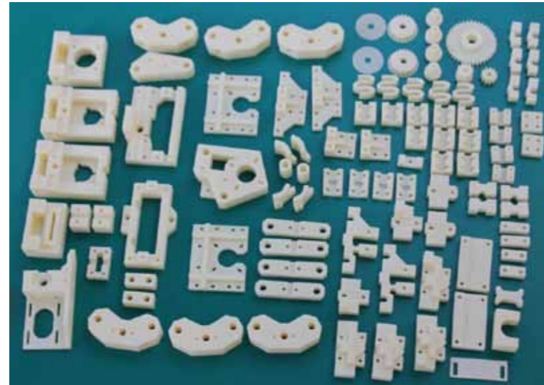
Reproduzierbare Bauteile eines „Mendel“ im Überblick
