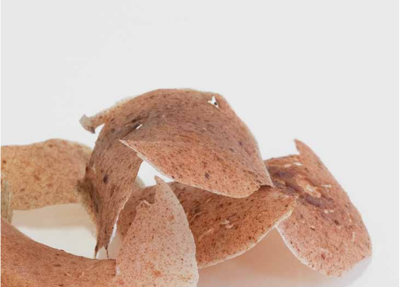
Rohmassen nach dem Trocknen auf Gips 48H
