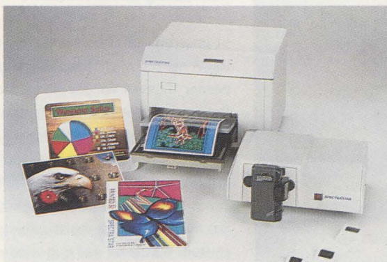
136 SpectraStar 450 Er druckt mit 300 dpi und trägt huckepack den Diabelichter Slide-Maker, der die Daten des Drucker-RIPs übernimmt.
