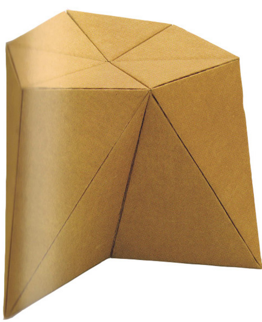
Weiche, biegsame Materialien mit geringer Materialstärke bekommen durch Falten Stabilität und sind so druckbelastbar.
