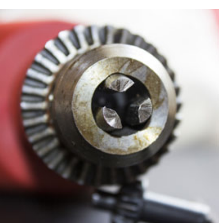
Kegelverbindungen gewährleisten einen genauen, zentrischen Sitz und damit höchste Genauigkeit.
