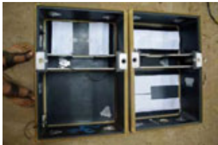
Laminieren der Innenkanten Takus mit Presswerkzeugen aurovillianischer Art.
