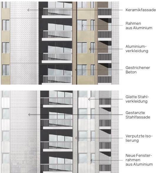
Sanierung der Fassade durch das Ateliers Lion Grundriss eines Wohnturms mit sanierter Fassade im Maßstab 1:250
