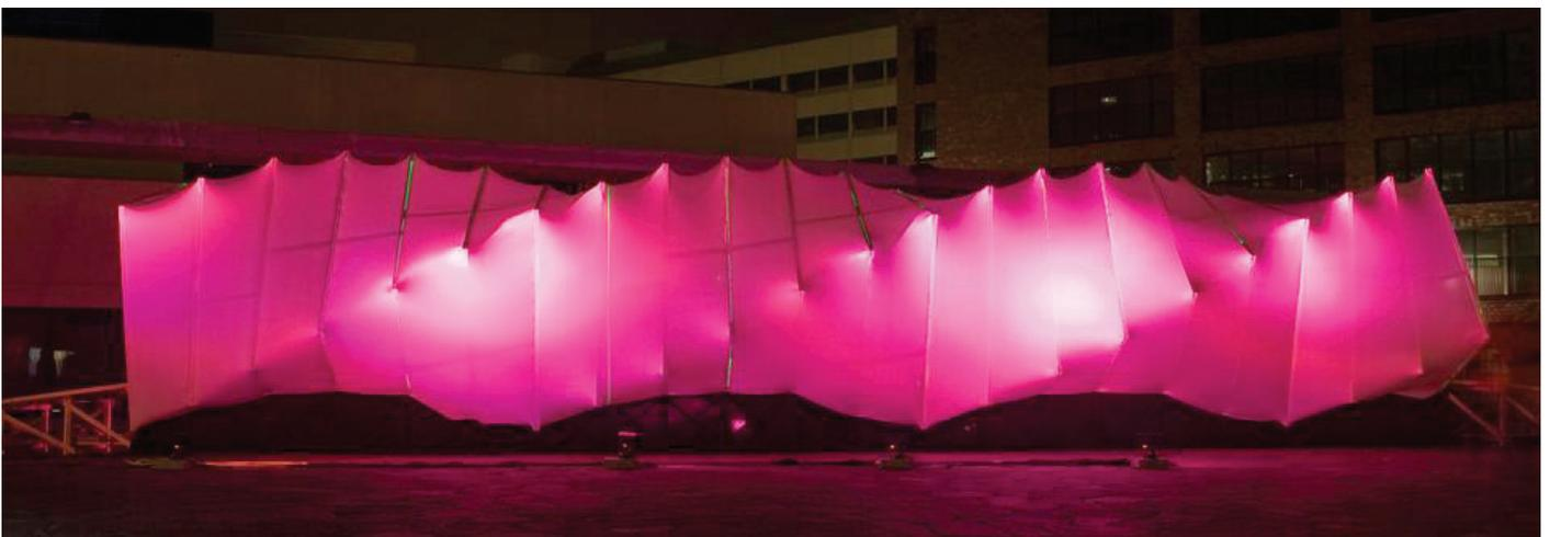
Die temporäre Installation wurde mittels handelsüblicher Dachlatten realisiert: Diese wurden zu 22 quadratischen Rahmen verschraubt und um jeweils 15° zueinander verdreht an dem hölzernen Steg aufgefädelt. Über diese raffinierte Holzunterkonstruktion spannen sich 150 Quadratmeter elastisches Stretch-Gewebe, das dauerhaft imprägniert wurde.
