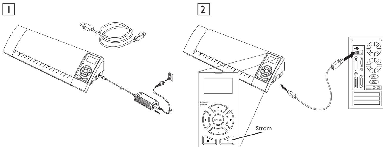
Schalten Sie die Maschine an, indem Sie den An-/Ausmacher betätigen. Wenn Ihr PC das „Neue Hardware gefunden“-Dialogfenster angezeigt hat, dann sollten Sie den empfohlenen Anweisungen folgen, um den SILHOUETTE CAMEO-Treiber zu installieren.
