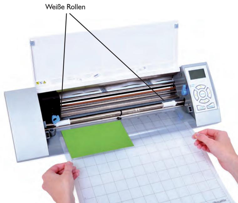
Um die Schneidematte in die SILHOUETTE CAMEO einzulegen, muss zuerst die Maschinen-Abdeckung aufgeklappt werden. Danach wird die Matte zwischen die weißen Rollen gelegt und die Enter-Taste (Eingabetaste) gedrückt (während „Load cutting mat“ (Schneidematte laden) auf dem LCD-Display ausgewählt ist).
