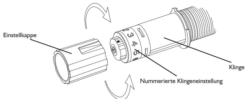
Um die Klinge wieder in Ihre SILHOUETTE CAMEO einzuspannen, entriegeln Sie den Klingenhalter durch Drehen des Feststellhebels entgegen dem Uhrzeigersinn. Legen Sie das Klingengehäuse in den Klingenhalter und drehen Sie den Feststellhebel nach rechts, um die Klinge sicher zu befestigen. Versichern Sie sich, dass das Klingengehäuse fest in dem Klingenhalter eingesetzt ist.
