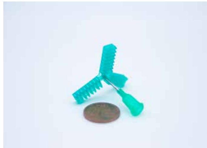
Modell eines pneumatischen Greifer aus 3D gedrucktem Silikon, der in der für minimalinvasive Eingriffe in der Medizin eingesetzt werden könnte
