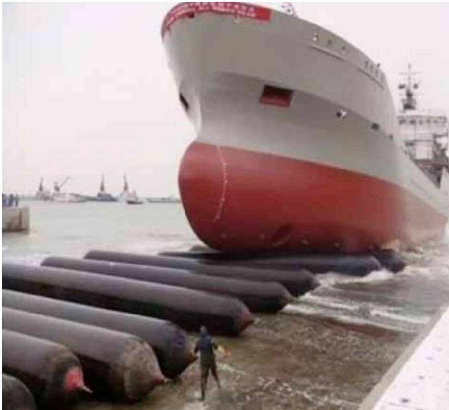
Hebekissen auf einer Werft. Das Schiff kann nicht nur angehoben sondern auch bewegt werden
