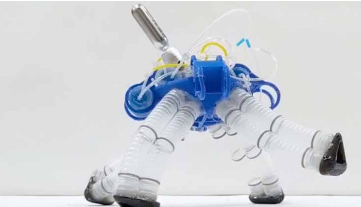
Laufroboter, der ohne Elektronik, dafür mithilfe einer Gaskartusche angetrieben wird
