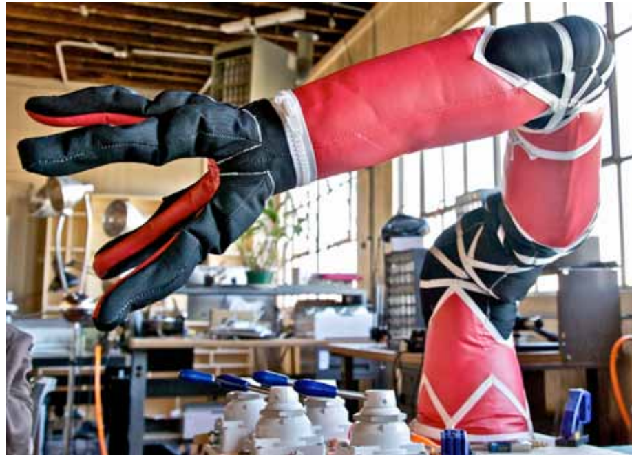
Pneumatischer Greifarm aus textiler Außenhülle von Otherlab
