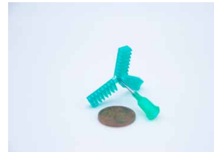
3D gedruckter miniaturisierter Soft Gripper, der sich für medizinische minimal-invasive Eingriffe eignen könnte
