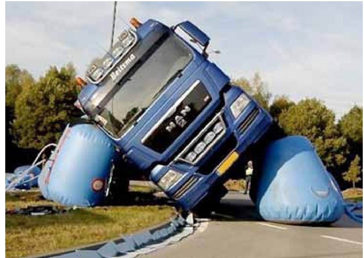
mit großen Hebekissen können auch havarierte Fahrzeuge geborgen werden
