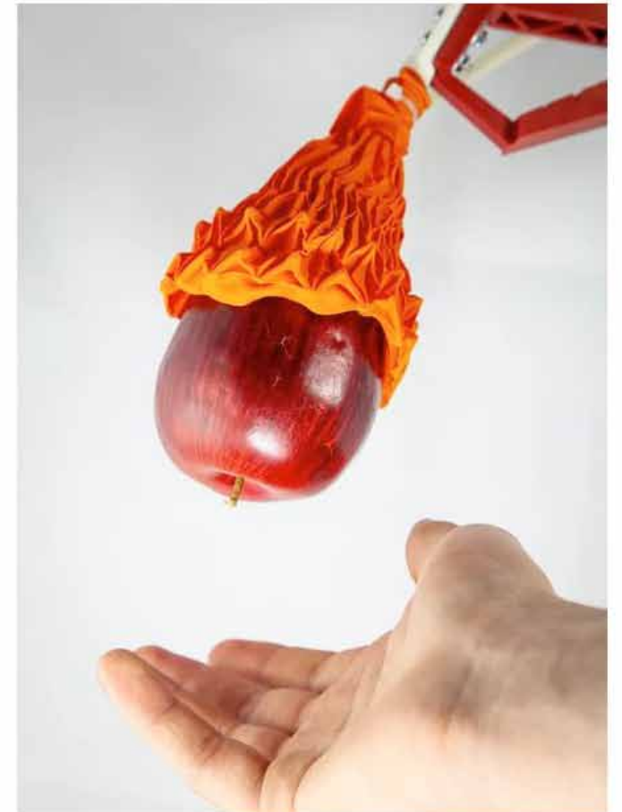
Pneumatischer Greifer mit origamiartigem Skelett
