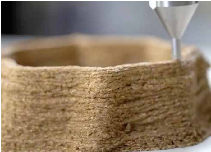
3D Druck mit Myzel, Julia Kraye, Fraunhofer-Institut
