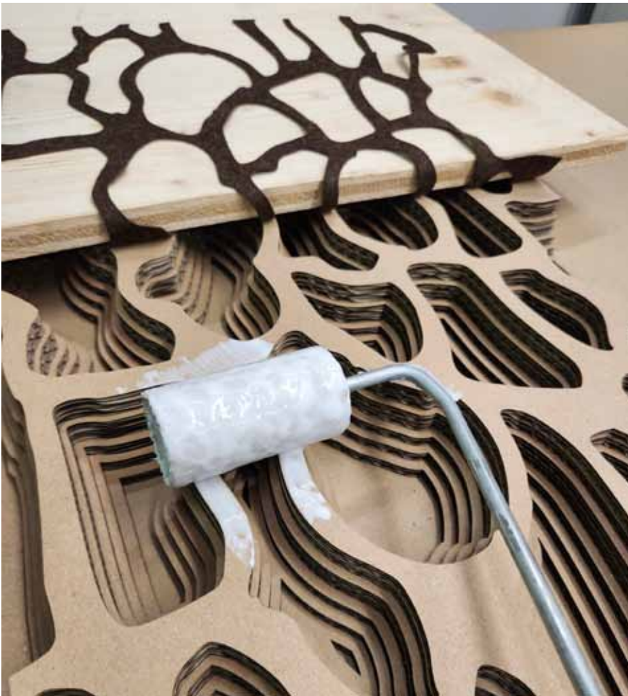
Aufleimen der oberen Lodenschicht
