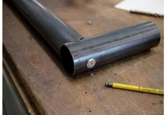
Spannverbindung mit Gewindestange und Hülsmutter
