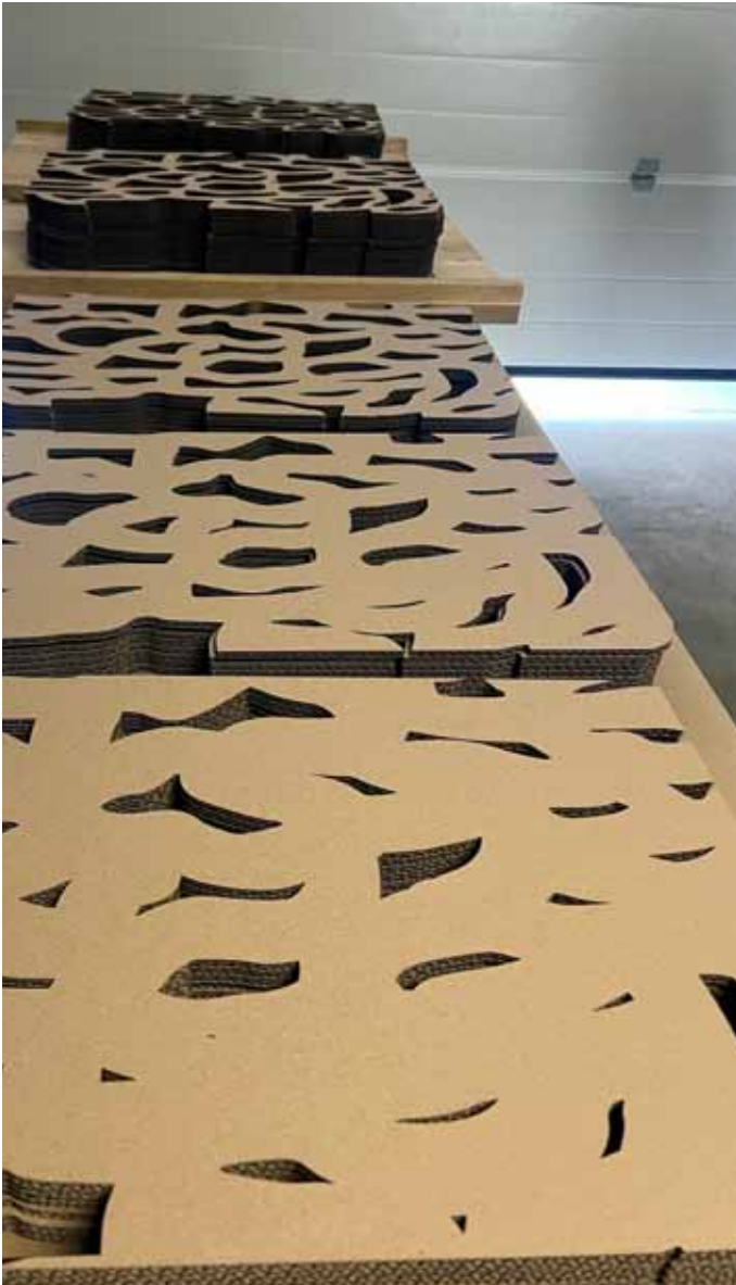
Alle gelaserten Platten für acht Paneele
