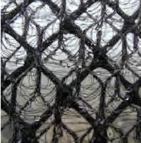
Eine SMARTE Idee mit einem NICHT smarten Material. In einem Dorf auf dem hohem Berg, wo man schwer an Trinkwasser gelangt kann man mit Kunststoff-Netzen sammeln. Das Prinzip ist sehr einfach. Die feuchte Luft enthält Wasser. Wenn der Wind gegen das Nebelnetz kommt, sammeln sich Wassertropfen und irgendwann kommen alle Wassertropfen nach unten und werden in einem Wassertank gesammelt.
