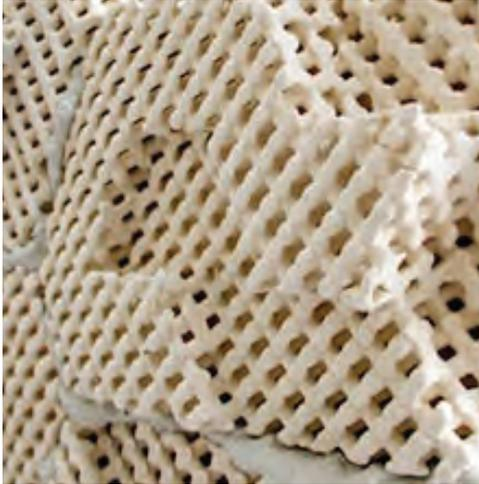
Mit der „Cool Brick“ haben die Architekten Virginia San Fratello und Ronald Rael von Emerging Objects aus Oakland eine Möglichkeit gefunden, die bereits in der Antike bekannte Technologie der Wasserdampfkühlung in die moderne Architektur zu transferieren. Lange Zeit bevor die Grundlagen für die heutige Klimatisierung und Kühlung von Räumen entwickelt wurden, machte man sich den Effekt zunutze, durch die Zugabe von Wasserdampf in die Luft, eine Absenkung der Temperatur herbeizuführen.
