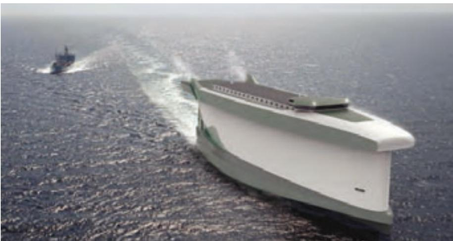
Der Rumpf dieses Schiffe funktioniert wie ein Segel. Der vorbei strömende Wind entwickelt sich zu Vortrieb. Diese Methode soll bis zu 60% an Kraftstoff einsparen.
