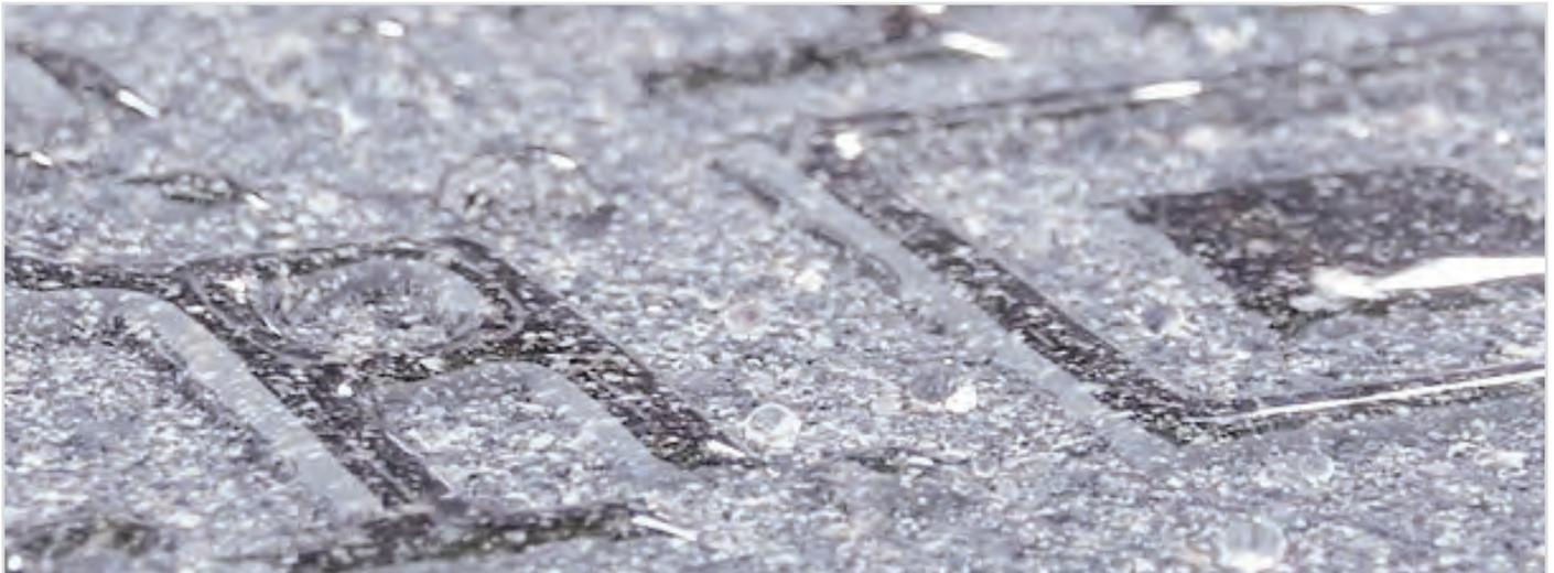
Am Anfang ist das zuvor Gesprühte unsichtbar, aber sobald es regnet wird das Motive sichtbar, da die besprühte Fläche stark wasserabweisend ist und der Untergrund daher trocken und somit hell bleibt.
