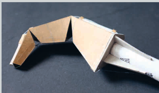
Kinetischer Finger mit Zugseil
