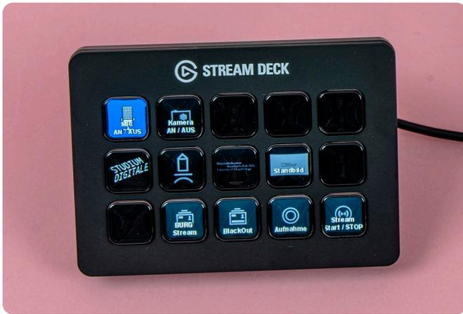
Das StreamDeck der Firma Elgato ist eine Hardware, über die auf 15 LCD-Tasten Voreinstellungen für den Stream gespeichert werden können. Auf dem StreamDeck sind einige Voreinstellungen bereits gespeichert: Kamera an/aus, Mikrofon an/aus, Standbilder mit dem BURG-Logo und das BURG-Logo als Logo-Overlay über dem Kamerabild, Blackout mit BURG-Logo (auch Ton aus), Aufnahme, Stream starten.
